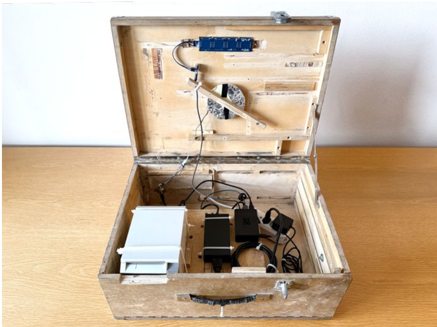
Abb. 31 | RFID Reader, Raspberry Pi, Thermodrucker und Display, untergebracht in einer alten Werkzeugkiste
